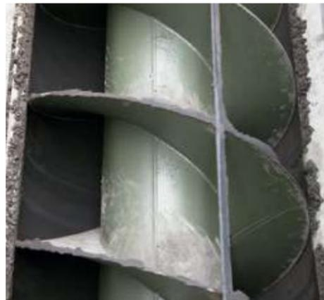
Barra do limpador soldada à hélice do parafuso. À medida que gira garante a planicidade e a precisão no acabamento da superfície da calha
